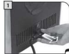
1 Die Maschine ausschalten und den Netzstecker ziehen.
